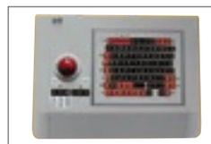
Fig. 2 : Clavier à track-ball pour personnes à mobilité réduite
