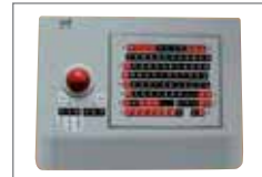
Abbildung 2: Tastatur mit Mausersatz für motorisch eingeschränkte Menschen
